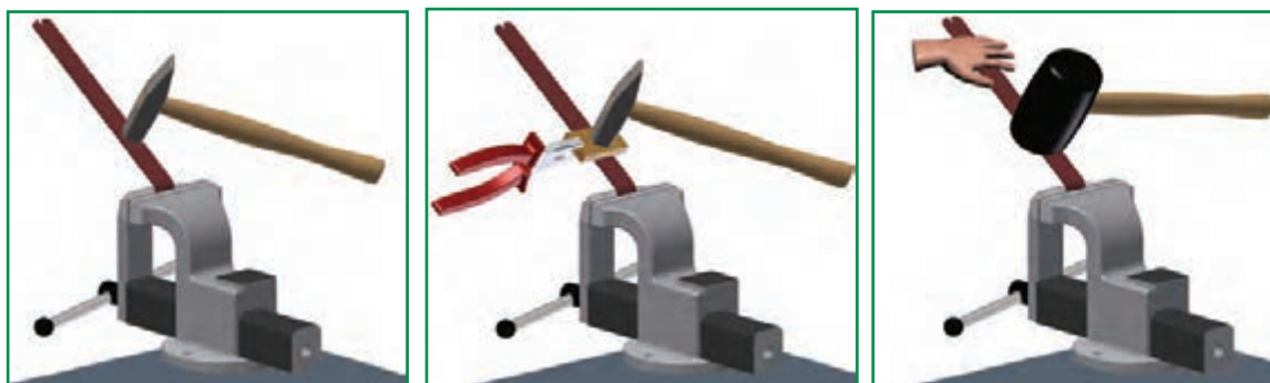
پ) خم کاری با چکش فلزی
