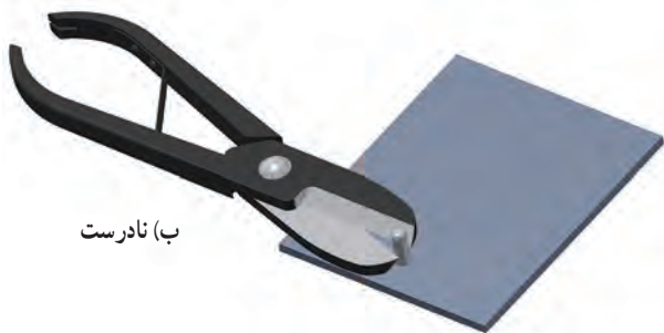
شکل ۸-۵. روش استفاده از قیچی
