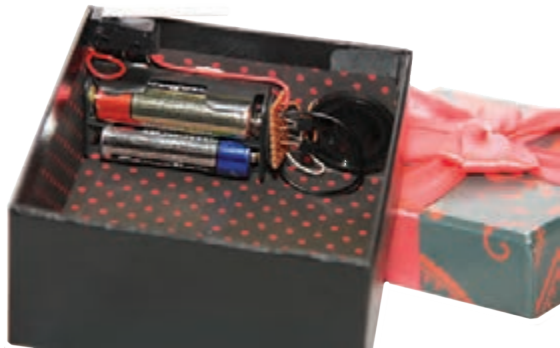
شکل ۲۸-۴. جانمایی مدار پروژه و کلید
