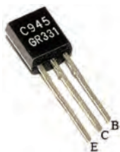
پ) پایه‌های یک نمونه ترانزیستور
