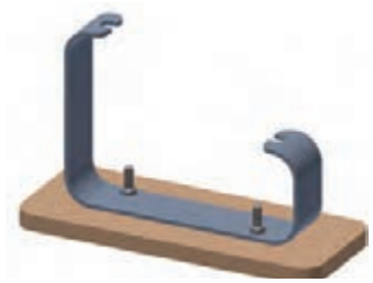
شکل ۳۹-۵. متصل کردن قطعه‌ها با پیچ و مهره
