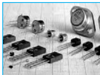
الف) شکل ظاهری چند نمونه ترانزیستور
