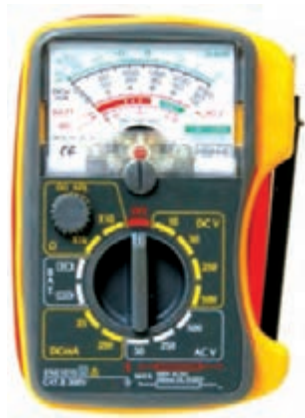
الف) مولتی‌متر عقربه‌ای
