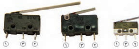
ب) چند نمونه میکروسوییچ
