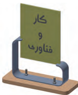
شکل ۴۱-۵. قرار گرفتن شیشه‌ها در شیارهای قاب عکس
